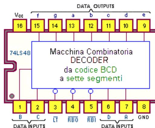
Ciascuna delle sue uscite è caratterizzata, rispetto alla normale **Totem-pole**, dalla presenza di un **resistore** interno di **pull-up**, il cui valore di **resistenza** è pari a **2k**; lo scopo di questa originale scelta funzionale è quello di assicurare **maggior corrente erogata**, in sintonia con le nostre precedenti osservazioni sul fatto che le **uscite TTL** non sono (nella norma) adatte a questo servizio.
