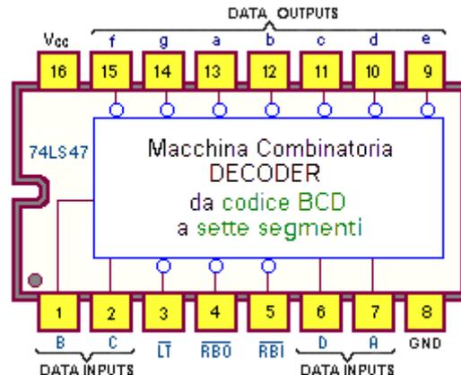
Ciascuna delle sue uscite è dotata di un **driver** di tipo *open-collector* cioè si avvale di una tecnica *diversa* da quella *Totem-pole* trattata in precedenza; lo *stadio finale* del componente logico è ora un semplice transistor con *emettitore* collegato regolarmente a massa e *collettore* collegato direttamente all'uscita, senza nessun vincolo con la *sua* alimentazione interna.
