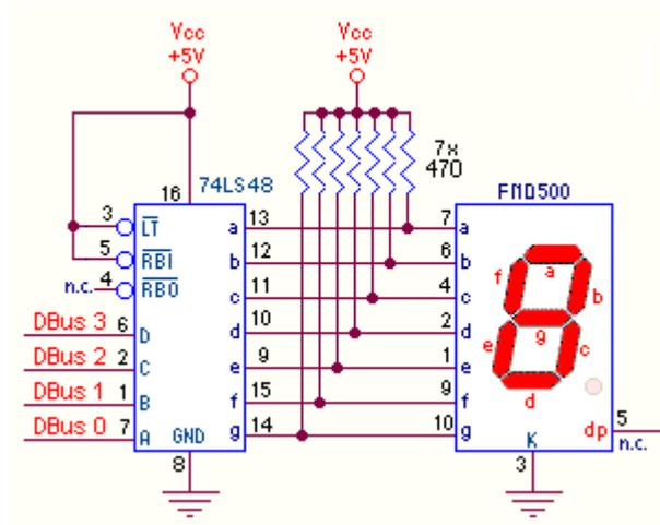
Nel normale funzionamento, i tre *pin di controllo*, **LT** (pin3), **RBO** (pin4) e **RBI** (pin5), possono essere *inattivi*, lasciandoli *scollegati* o meglio collegandoli a **+5V**.
