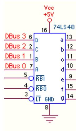
L'impiego di questo **Decoder 74LS48** con un normale **digit a catodo comune** è dunque possibile **solo** con l'impiego di **resistori** addizionali esterni di *pull-up* su ciascuna delle 7 linee d'uscita; la scelta del valore di *resistenza* è legata all'intensità luminosa desiderata per i *segmenti-led*; va da se che non è il caso di scendere a valori troppo piccoli per non rischiare di bruciare le uscite del componente.
