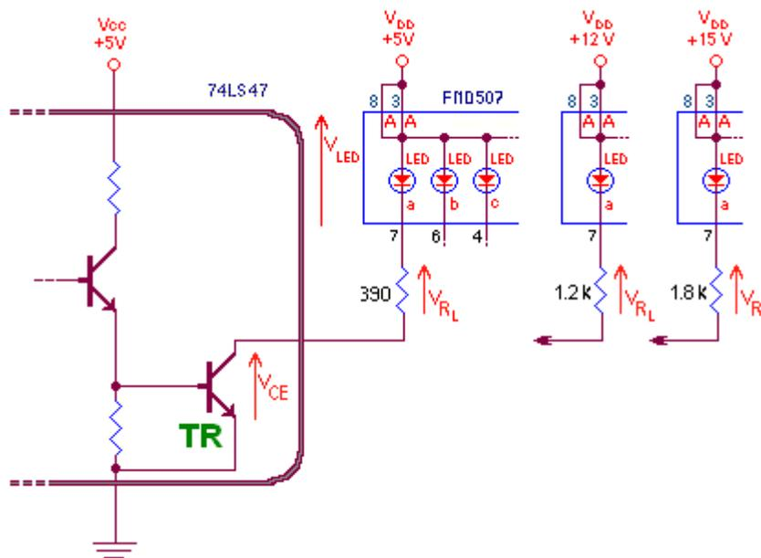
Il fatto che il **collettore** del transistor **TR** sia **aperto** (cioè non collegato a nulla, *fluttuante*) ci obbliga a collegare un **carico** esterno in grado di *chiudere il circuito d'uscita* verso una *tensione positiva*, al fine di consentire il funzionamento del transistor stesso; di solito si utilizza un **resistore**, detto di *pull-up* per significare (nel pittoresco modo di esprimersi degli anglosassoni) che il potenziale dell'uscita va "*tirato su*" verso l'alimentazione esterna.
