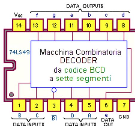
Le sue uscite sono di tipo **open-collector**, cioè il suo *stadio finale* è caratterizzato dalla presenza di un transistor con *emettitore* collegato a massa e con *collettore* lasciato **aperto** in uscita (cioè non collegato a nulla); anche questo **Decoder** non è adatto alla gestione diretta di un normale **digit**, essendo stato progettato per pilotare una logica TTL o per essere anteposto ad un **driver** per il controllo di **lampade**.
