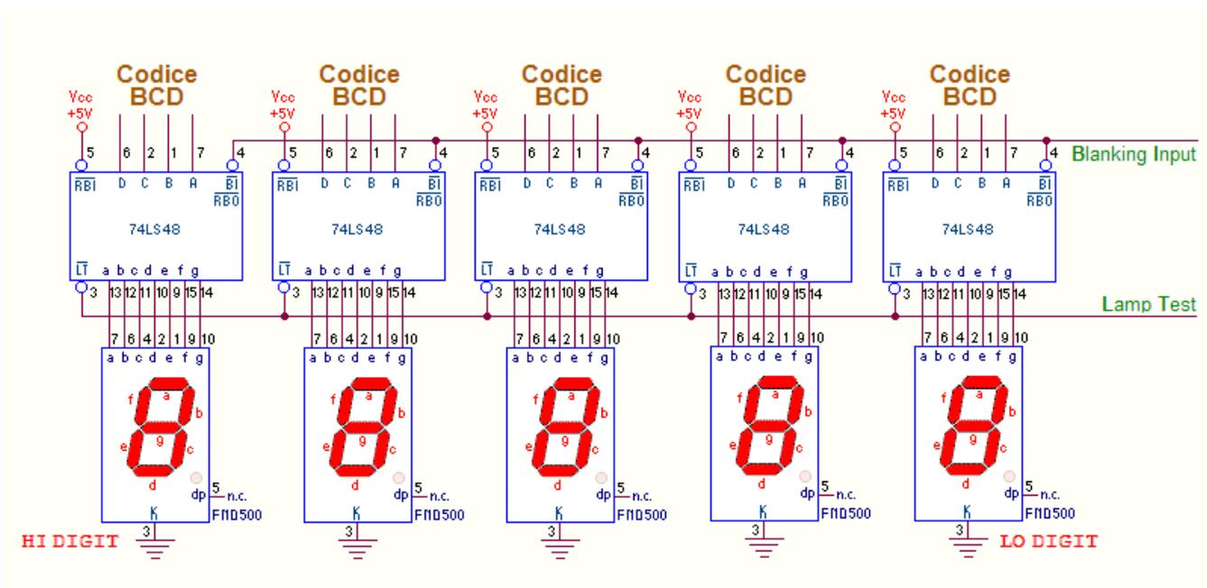
La tecnica di **Blanking** (**spegnimento**) può essere usata anche per controllare l'**intensità luminosa** del visualizzatore; è sufficiente applicare sul **pin4** un'**onda quadra non simmetrica** e modificare il suo **duty cycle**; come è noto questo parametro esprime (anche in percentuale) il rapporto tra la **durata** della **parte alta** e il **periodo** del segnale:
