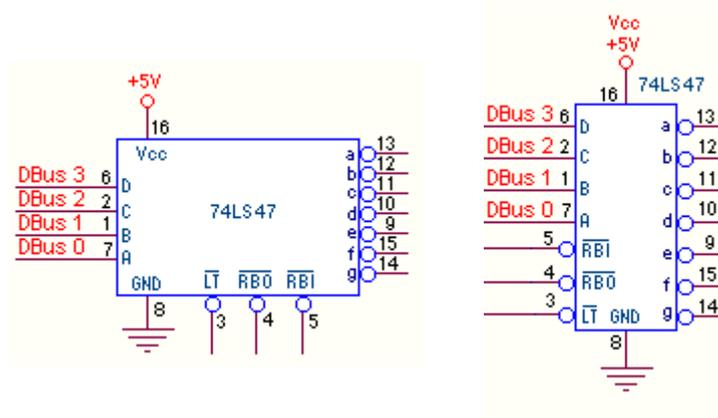
Nel normale funzionamento, i tre *pin di controllo*, **LT** (pin3), **RBO** (pin4) e **RBI** (pin5), possono essere *inattivi*, lasciandoli *scollegati* o meglio collegandoli a **+5V**; per capirne il funzionamento dovremo pazientare ancora un po' ...
