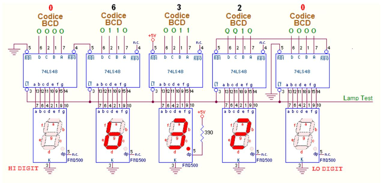
Ripetiamo l'analisi del visualizzatore precedente, ora organizzato per visualizzare la *parte intera* di un numero sui primi tre **digit** e la *parte frazionaria* sugli ultimi due; la situazione è evidenziata dalla presenza del *punto decimale* acceso permanentemente sul **digit** centrale. L'ipotesi di lavoro è che i **codici BCD** in ingresso ai cinque **Decoder** siano ora quelli corrispondenti alle cifre **06320**; la gestione della *parte intera* è identica a quella già descritta:
