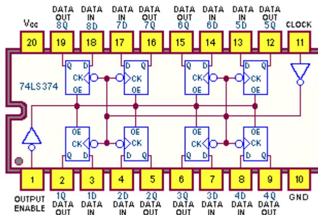
Esso contiene **8 elementi di memoria (flip-flop)** di tipo **D-Type**, controllati *contemporaneamente* da un unico piedino di abilitazione (pin 11, **Clock CK**).
