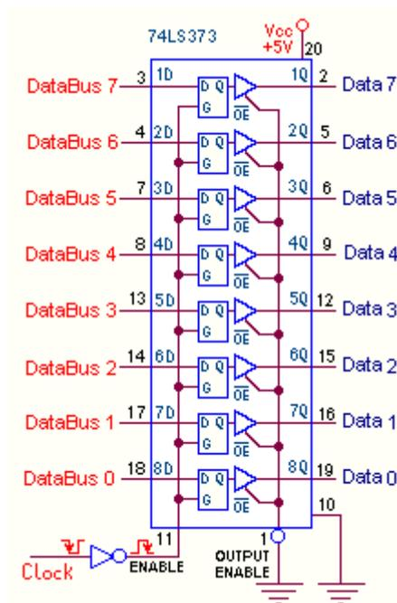
Lo **schema a blocchi** del precedente disegno può essere sostituito, nei nostri schemi, con la seguente versione più compatta:
