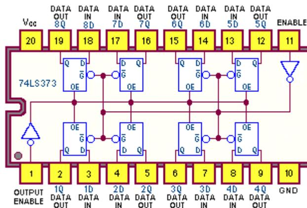
Esso contiene **8 elementi di memoria (flip-flop)** di tipo **D-Latch**, controllati contemporaneamente da un unico piedino di abilitazione (pin **11**, **Enable G**).
