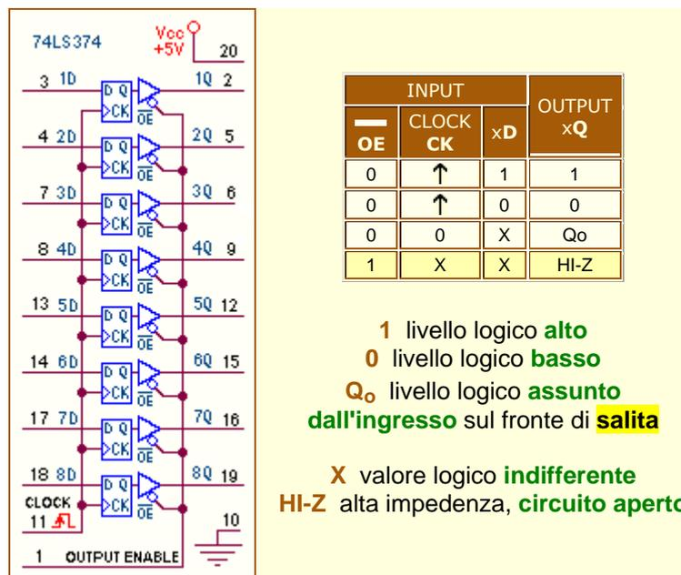
E' importante capire cosa significa mettere un'uscita in **alta impedenza**; supponiamo di collegare una tensione ad un resistore:
